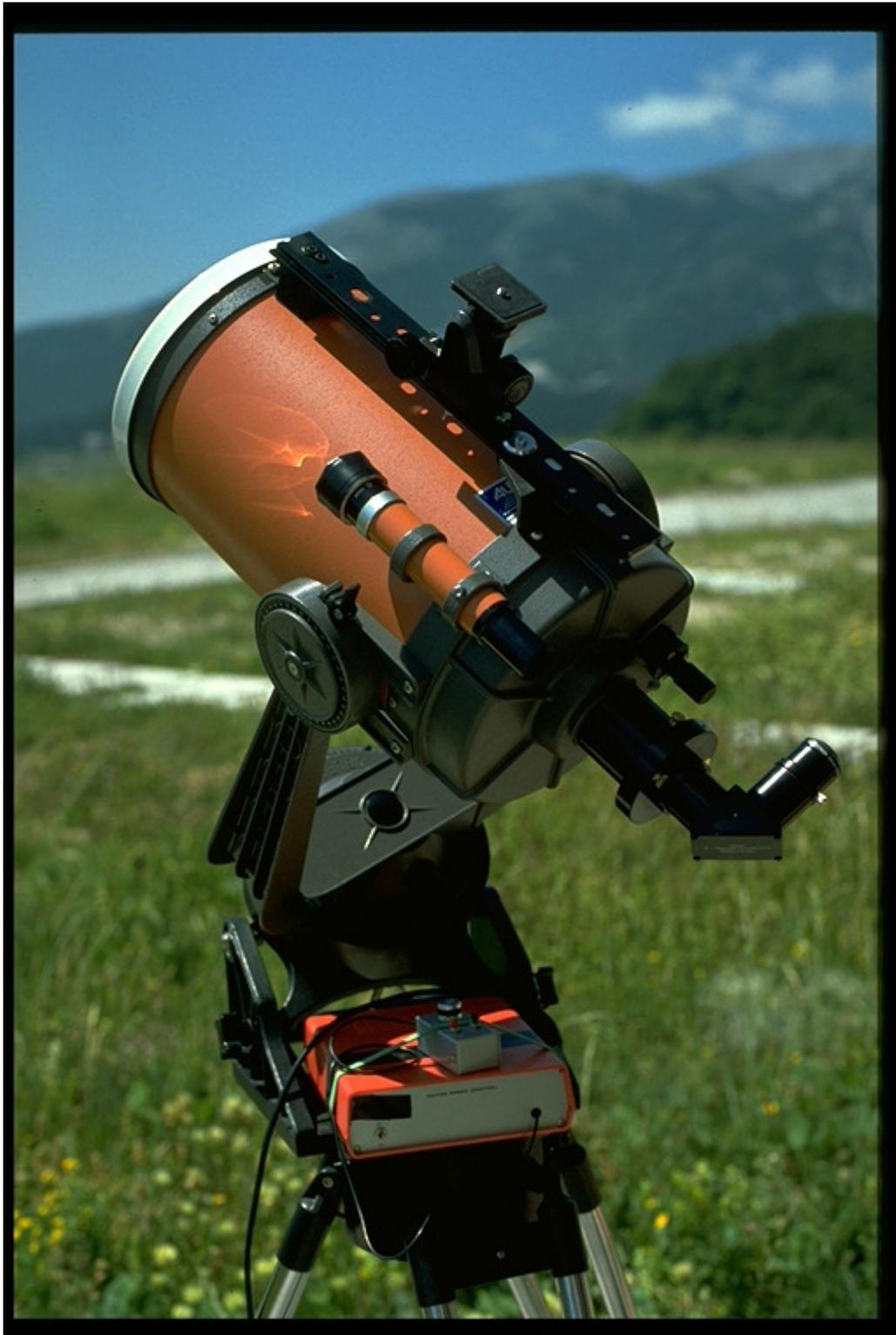
**Il Celestron 8" che avevo acquistato nel 1986 munito di un filtro interferenziale Lumicon da 1,5A per l'osservazione delle protuberanze sul sole**
